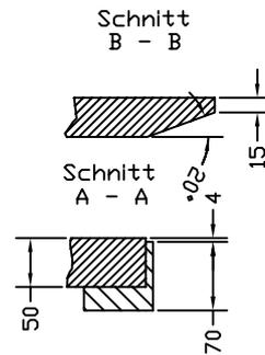
Schema für Einbau der Kasse mit Zähltablett "EXPRESS" 945-M
